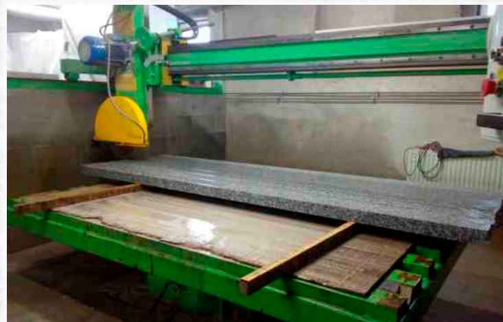
Řezání - mostová pila (formáty až 340cm)
