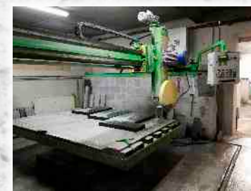
Řezání - mostová pila (formáty až 340cm)
